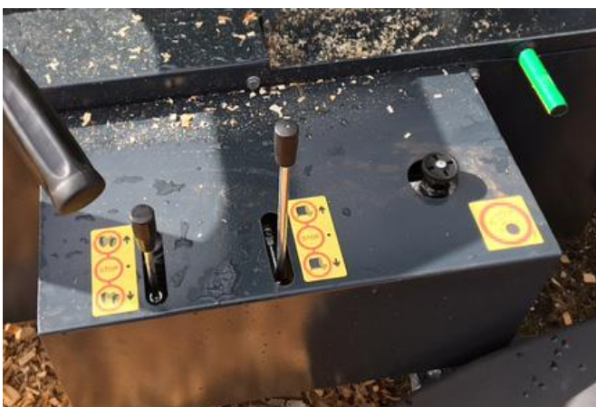
Управление 2 рычагами (подача бревна и распиловка). Справа - регулятор скорости распиловки.
