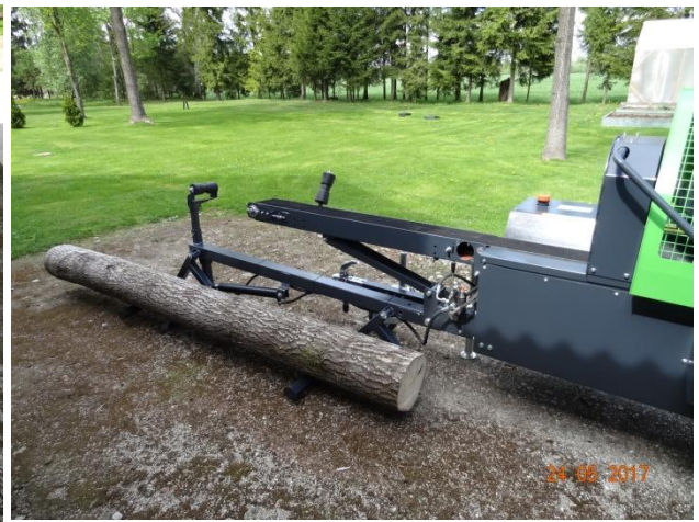
Подъём бревна Максимальный диаметр бревна 38 см.
