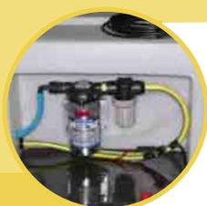
Kit innaffiante a pressione completo di serbatoio da 125 litri, pompa 12 V e ugelli nebulizzatori (solo RCVL)
