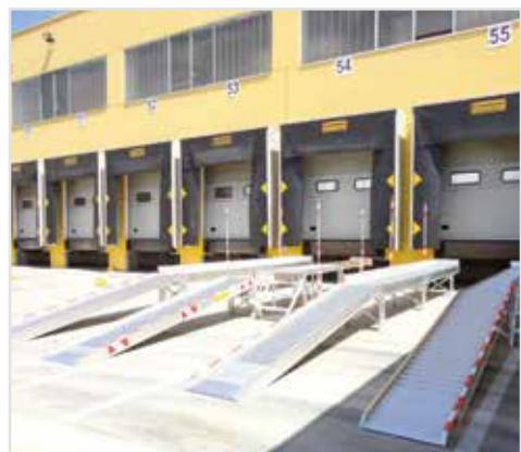
Definitive CLM propone cunei di rialzo veicoli che permettono di portare il pianale dei furgoni al livello delle banchine di carico e scarico dei magazzini logistici, per agevolare e rendere sicure le operazioni di carico e scarico, riducendo notevolmente i tempi dell'operazione.
