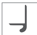
APPOGGIO A GOCCIA BOTTOM HOOK CONNECTION
