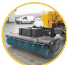
Kit innaffiante a pressione completo di pompa elettrica, ugelli nebulizzatori e serbatoio da 100 lt.
