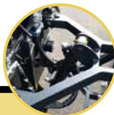
Rotatore idraulico completo di elettrovalvola per sdoppiamento funzioni idrauliche
